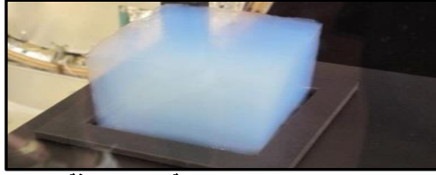
شكل (11) مادة الأيروجيل العازلة و الشبه شفافة و مدي خفة وزنها. (ش)
